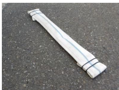
消防用ホースを再利用した重石
