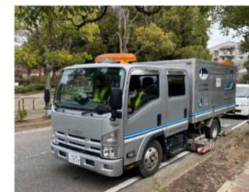
・レーダー探査による路面下空洞調査の事例
