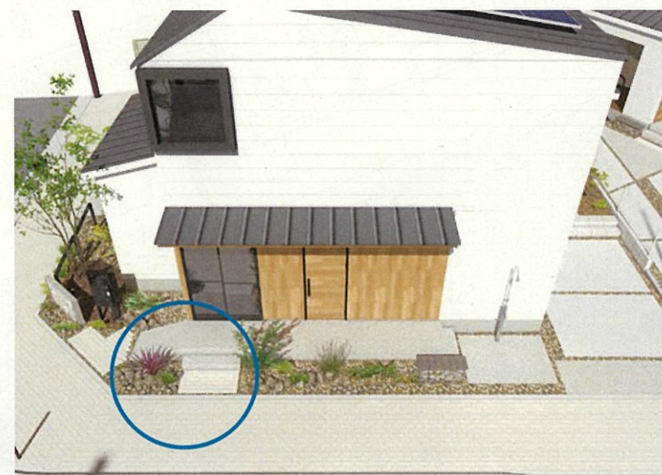
土間に駐輪出来るようスロープ設置
