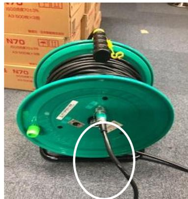
2：磁気誘導システムと電工ドラム（ループアンテナコード）を繋げます。
