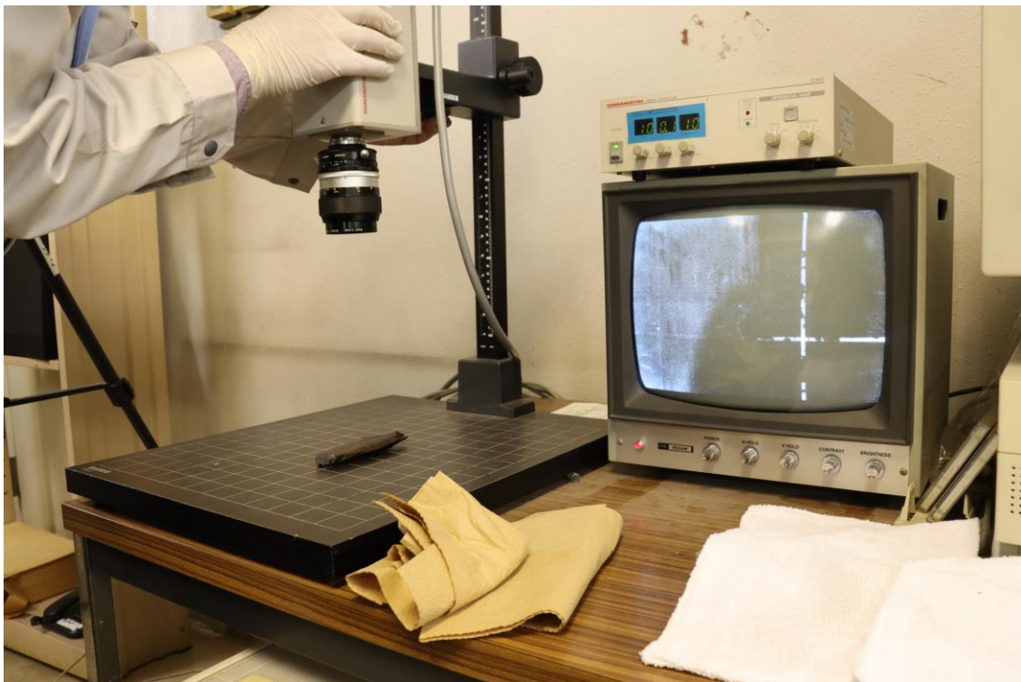
写真3 No.532の赤外線カメラ調査状況
