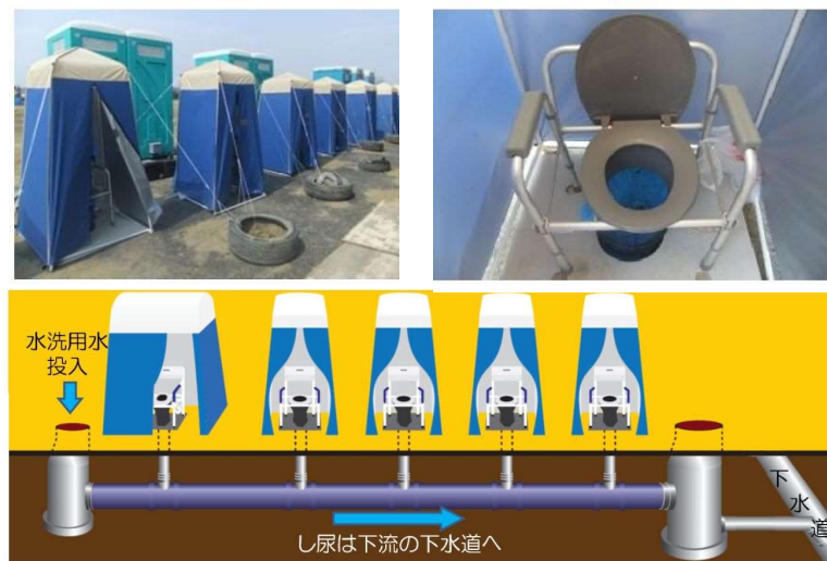
図 4.9 マンホールトイレシステム
