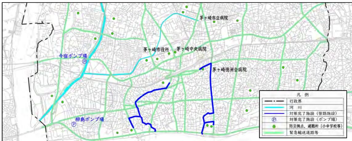
図 2.8 下水道施設の耐震化状況（令和 3 年度末時点）
