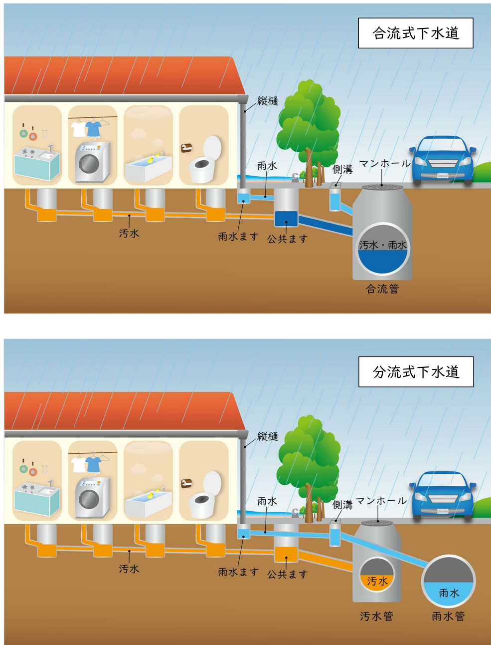
図 1.2 合流式下水道と分流式下水道の模式図
