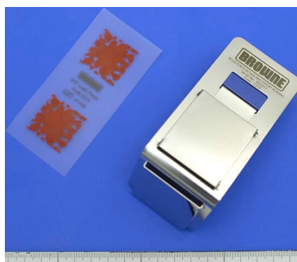
図7. WDs の洗浄効果の評価に使用する各種インジケータ
