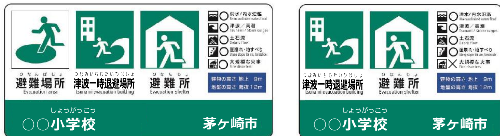
図 5.3 災害種別避難誘導標識システムに基づく指定避難所標識の記載例
