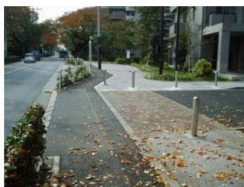
歩道と車道の交差部の舗装材を変え、運転者に注意を促している例 （武蔵野市サンヴァリエ桜堤）
