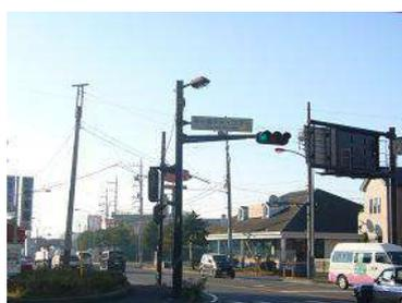
交差点部分の景観整序を行うために共架させた信号機と道路照明
