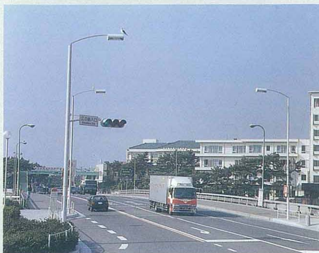
信号機の持ち出しアームも照明ポールに準じている
