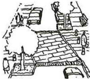
折れ曲がった車道と舗装の変化
