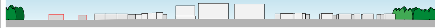
B地区高さ20m・その他高さ9m想定国道134号側立面図
