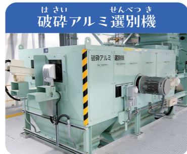
は さい せん べつ き 破砕アルミ選別機 かいてん じしゃく おく と 回転する磁石でアルミが奥に飛ばされて、 ほか ほか わ 他のゴミと分けられます。
