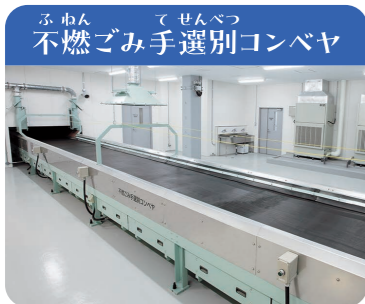
ふ ねん て せん べつ 不燃ゴミ手選別コンベヤ しより てき きけんぶつ こがたかでんるい 処理に適さない危険物や小型家電類が ま てきぎょう と のぞ 混ざっているので、手作業で取り除きます。
