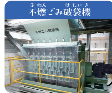
ふ ねん は たい き 不燃ゴミ破袋機 かいてん は こてい は ふくろ 回転する刃と固定された刃でゴミ袋を やぶ なかみ と だ 破って中身を取り出します。
