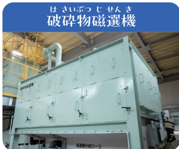
は さい ぶつ じ せん き 破砕物磁選機 こてい じしゃく ひ よ てつ 固定された磁石に引き寄せられた鉄がベルト おく はこ ほか わ で奥に運ばれて、他のゴミと分けられます。
