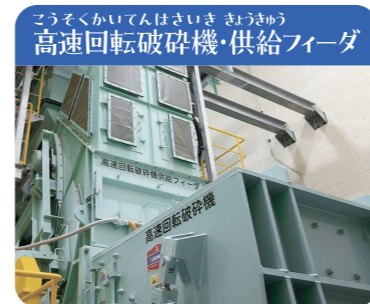
こうそくかいてんはさいきまわうきゆう 高速回転破砕機・供給フィーダ あらはさいき くだ 粗破砕機で砕いたゴミを、ここでさらに こま 細かくします。
