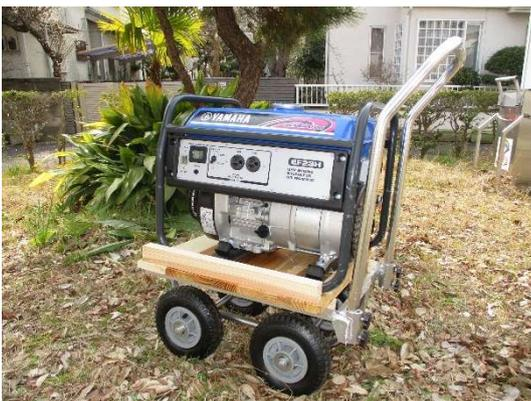
災害時に速やかに使用できるよう、あらかじめ発電機に台車を固定しています。最近では、倉庫の前が砂地のため、タイヤを大径のものに更新しました。
