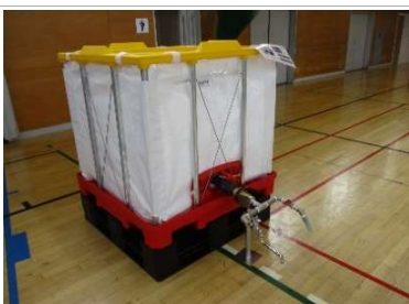
給水用コンテナ水槽(1t)
