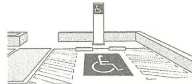
図3 車いす使用者駐車区画の例
