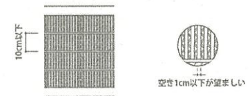
図3 柵目タイプの排水溝の溝ふた(ノンスリップタイプ)
