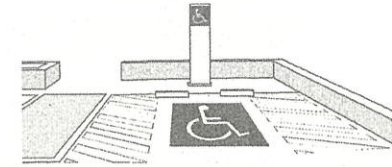
図2 車いす使用者駐車区画の例
