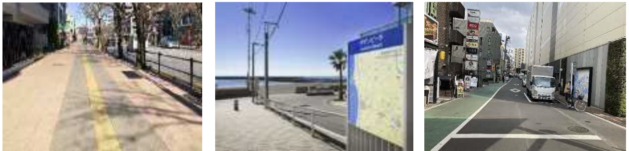
写真 視覚障がい者誘導用ブロック(左) 案内板・案内サイン(中) 安全対策(カラー舗装化)(右)
