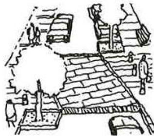
折れ曲がった車道と舗装の変化
